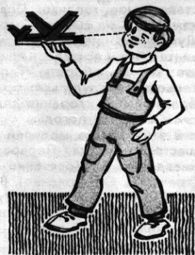
Рис. 3. Если, взглянув на модель спереди, ты заметишь, что одно крыло шире, это значит больше его угол установки, то есть угол между плоскостью крыла и верхней линией фюзеляжа.
